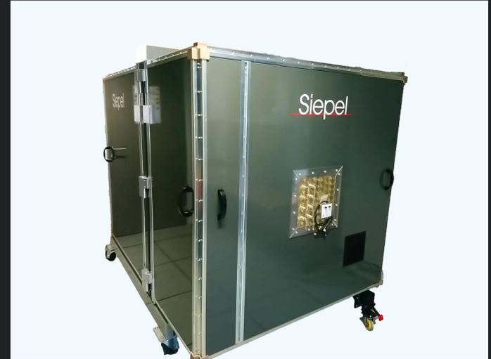
*Les parois sont recouvertes d'absorbants électromagnétiques définis selon la plage de fréquence désirée :*
